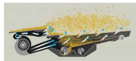
Abbildung 4.17: Reinigungsstufe im CLAAS LEXION 580 (Claas 2006b: 16)
