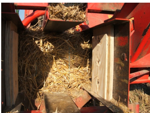
Abbildung 4.7 Symmetrische Verengung des Presskanals durch Einschrauben von Holzbrettern
