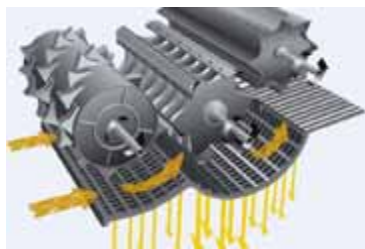
Abbildung 4.15: Dreschwerk des CLAAS MEGA (Claas 2006a: 8)
