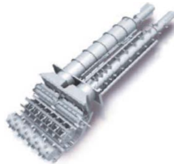
Abbildung 4.19: CLAAS LEXION 600 Hybriddreschwerk (Claas 2006c: 17)
