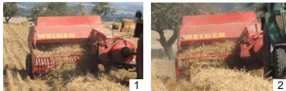
Abbildung 4.10: Schlecht ausgelastete Pickup (1). Gut ausgelastete Pickup (2)
