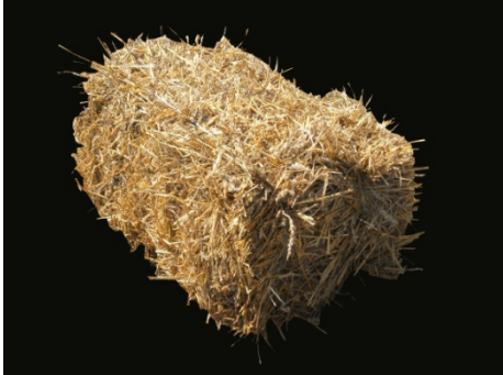
Abbildung 4.5 Lockere Ballen mit unscharfen Kan- ten müssen aufwändig vorbereitet werden, um als Baustrohballen eingesetzt werden zu können. Not- wendige Arbeiten sind das Trimmen (begradigen der Ballenenden), das Rasieren (entfernen überste- hender Halme vor dem Verputzen) und evtl. ein Nachverdichten. Ballen unter einer Rohdichte von 110 kg/m 2 sollten für das lasttragende Bauen nicht verwendet werden.
