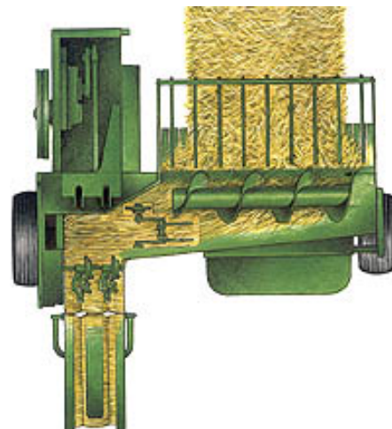
Abbildung 1.2 John Deere Hochdruck-Kleinballenpresse mit Förderschnecke (john-deere.de)
