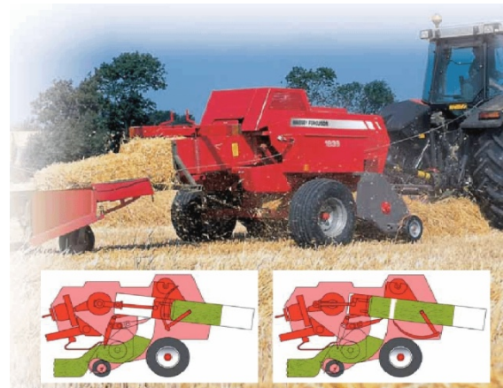
Abbildung 1.3 MF 1839 mit Center-Line-Technologie (verändert nach Massey Ferguson 2007: 2, 3)
