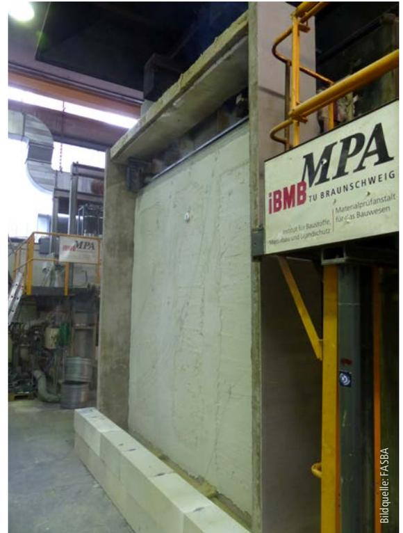
Bild 4: Brandprüfung einer mit Kalk verputzten Strohballenwand
