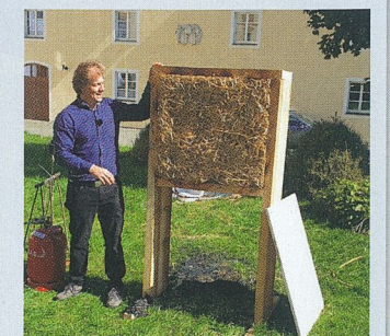
Nach 90 min wird die Platte an der Rückseite abgenommen. Die Strohdämmung war nicht einmal zur Hälfte durchgebrannt und das rückwärtige Stroh war nicht einmal warm.
