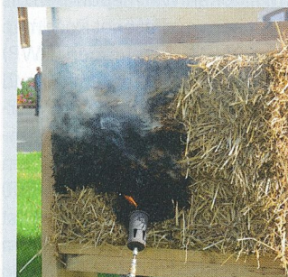
Der in ein Holz-Gefach gepresste Strohballen wird 90 min lang mit einem Gasbrenner beflammt. Zunächst verbrennen herausstehenden Strohhalme mit direktem Kontakt zur Luft, ...
