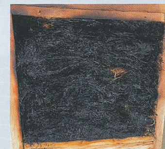
Strohballen nach 90 min Beflammung
