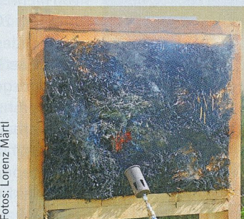
... danach frisst sich das Feuer langsam in die Dämmung hinein.
